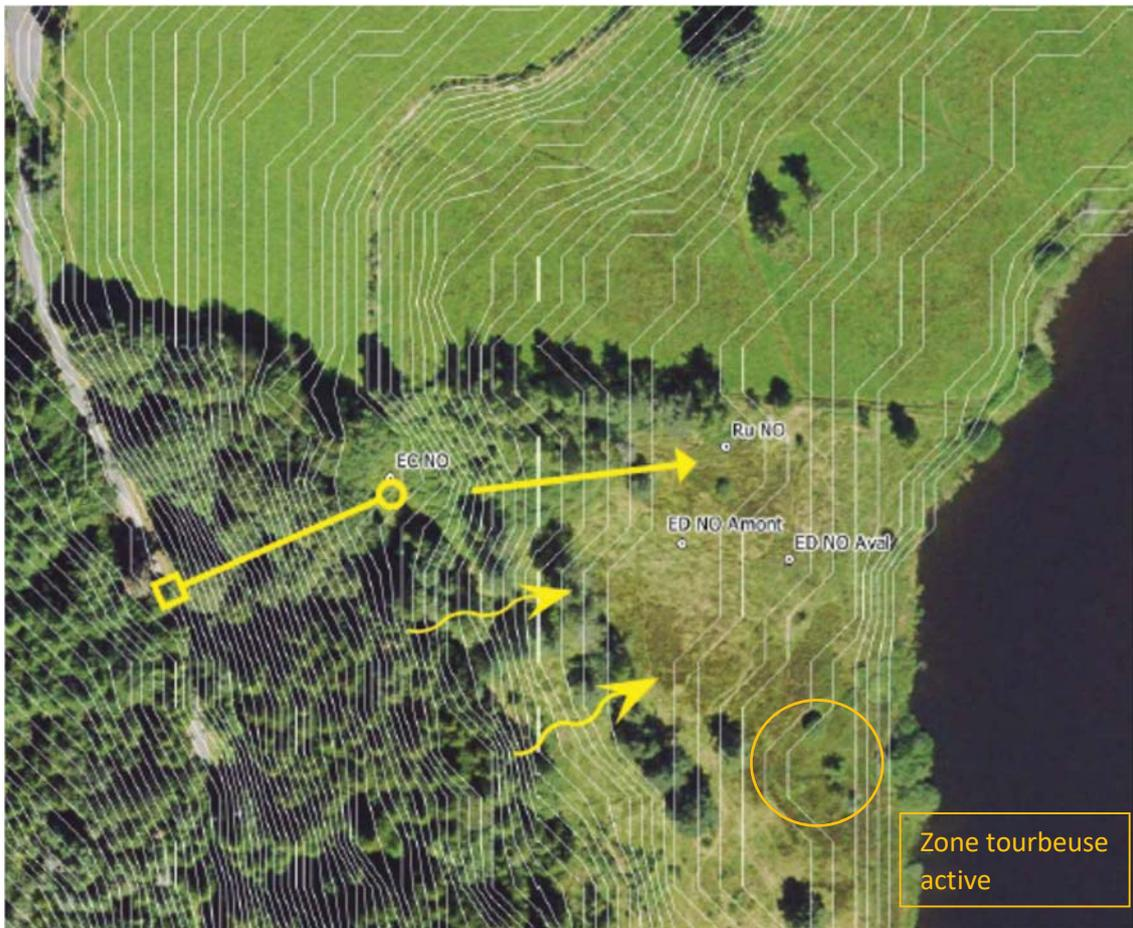
Figure 16. – Localisation des piézomètres, lignes topographiques d'amplitude 50 cm et type d'alimentation majoritaire des zones humides du nord-ouest (Source Goubet)
